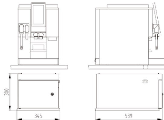
Unité frigorifique sous la machine à café
