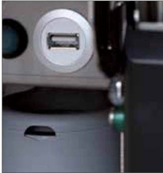
Clé USB librement accessible pour la sauvegarde des données et les mises à jour du logiciel.
